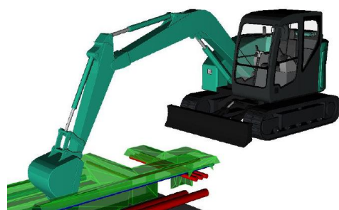
ICTバックホウを用いたの床掘り作業
