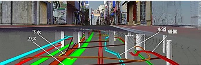
ジオ・サーチ(株) 地下埋設物を地上から正確に探査する新技術「地上・地下インフラ3Dマップ」を開発。3Dデータの活用により無電柱化工事的设计・施工の無駄をなくし、工期短縮します。
